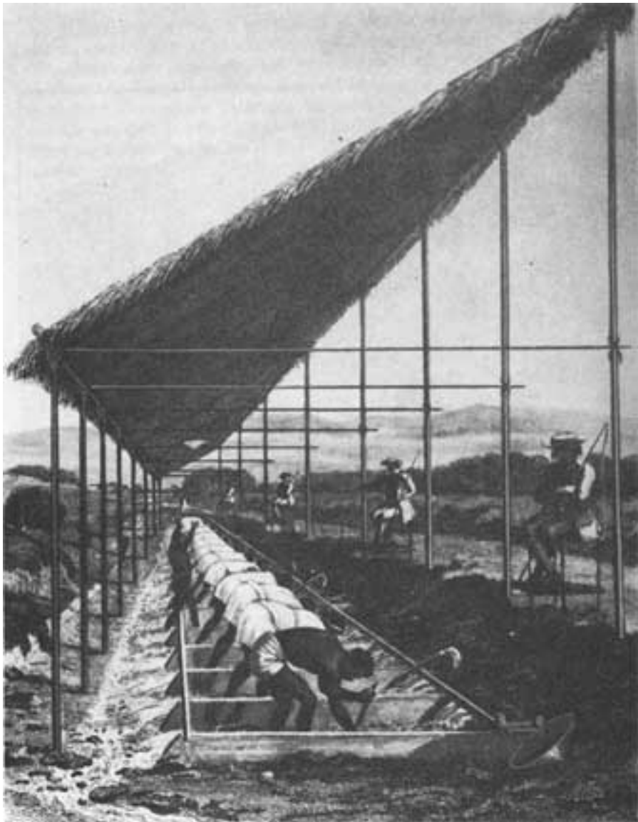
Escravos lavam minérios diamantíferos em Cêro Frio. Um deles, de pé, acusa, na palma da mão, a pedra encontrada. (John Mawe)
