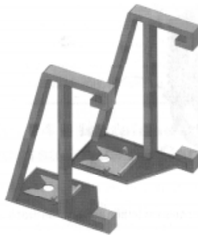
Suportes de fixação da ventoinha.
