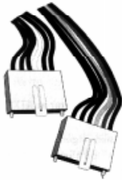
Plugues usados por fontes de alimentação AT.
