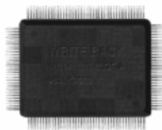
Detalhe do cache de memória falsificado.
