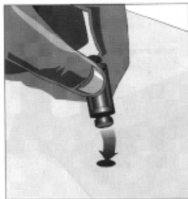
Instalando os pinos de fixação da ventoinha do processador.
