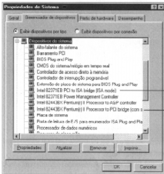
Chipset da placa-mãe sendo corretamente reconhecido (no caso, é um Intel 440BX).
