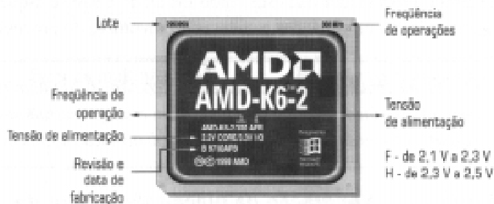
Identificando a tensão de alimentação em processadores AMD K6-2.
