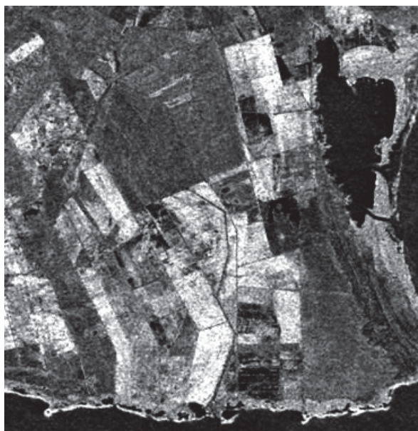
Fig. 4.16 Presença do ruído speckle (aspecto de sal e pimenta em toda a imagem) em uma cena do satélite canadense RADARSAT-1 da região de Lagoa dos Patos, RS.
