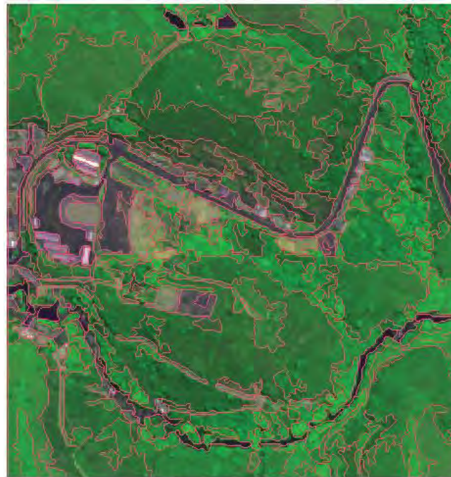
Fig. 13.8 Segmentação com limiar de similaridade = 15 e área (pixels) = 20 sobre composição RGB 342.
