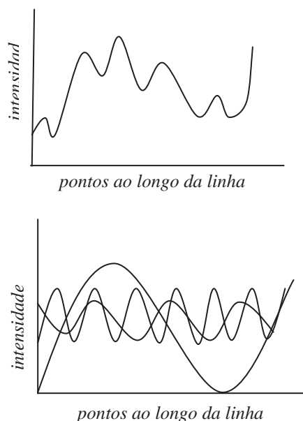
Fig. 11.18 Decomposição das frequências da imagem em seus componentes senos e cossenos (Adaptado de Crósta, 1999).
