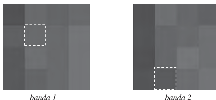
Fig. 10.3 Imagens de duas diferentes bandas contendo pixels de igual valor digital, mas que exibem valores de brilho diferentes. O pixel com contorno tracejado tem valor 52 nas duas bandas.
